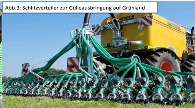
Abb.3: Schlitzverteiler zur Gülleausbringung auf Grünland
